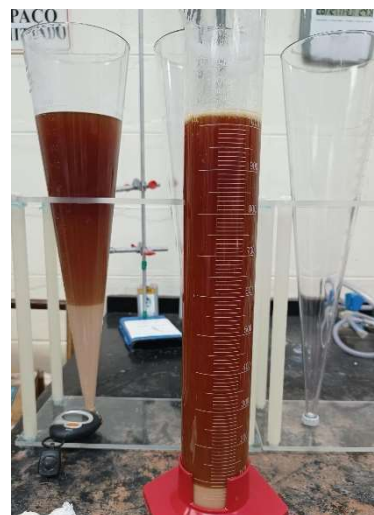
Figura 18 – Sedimentação da pasta
