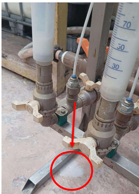
Figura 25 - Vazamento do produto devido pequena obstrução durante a montagem
