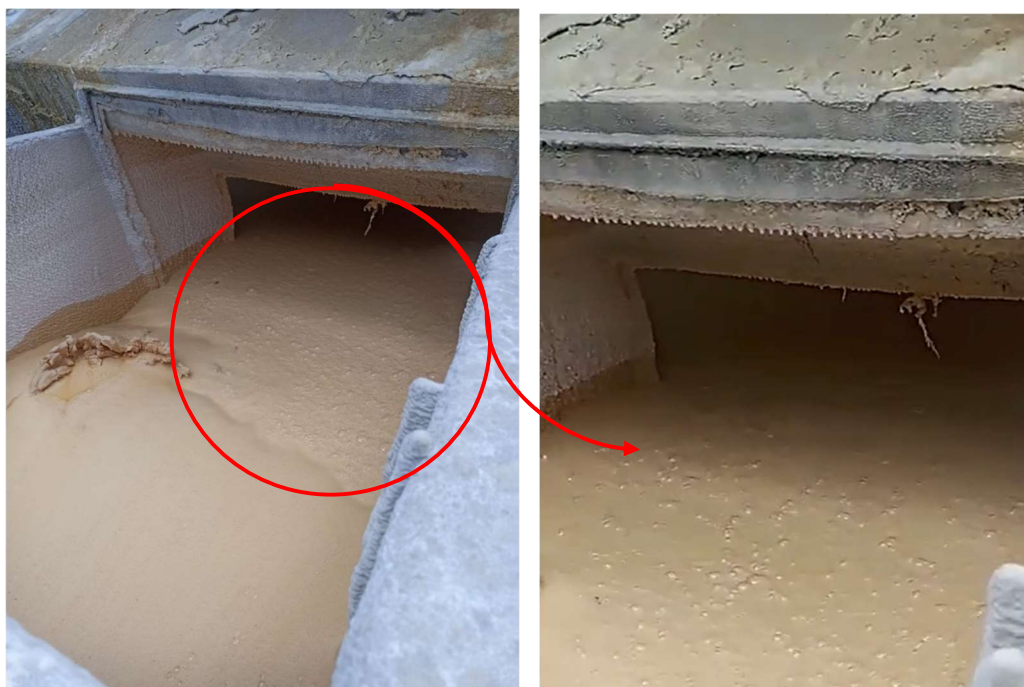
Figura 31 – Registros de espumas na calha de transbordo do tanque
