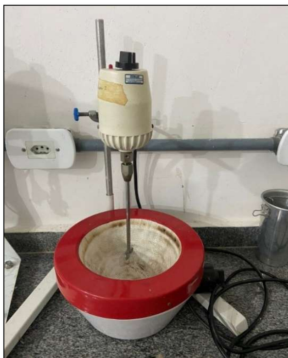
Figura 6: Agitador Mecânico (modelo 752, FISATOM, Brasil)
