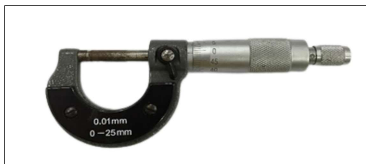
Figura 8: Micrômetro externo (modelo MDC-25S, CARBOGRAFITE, Japão)
