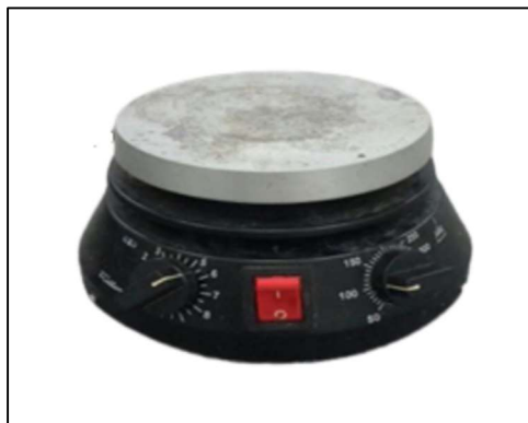
Figura 7: Agitador Magnético com aquecimento (modelo 752, FISATOM, Brasil)
