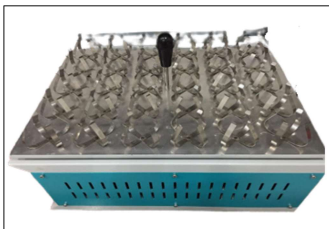
Figura 9: Mesa agitadora orbital (Tecnal, modelo TE-145, Brasil)
