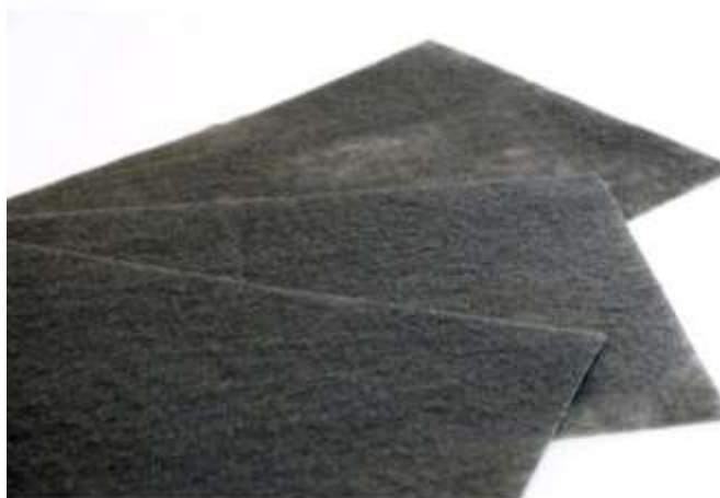
Figura 1 - Imagem do geotêxtil não tecido.
