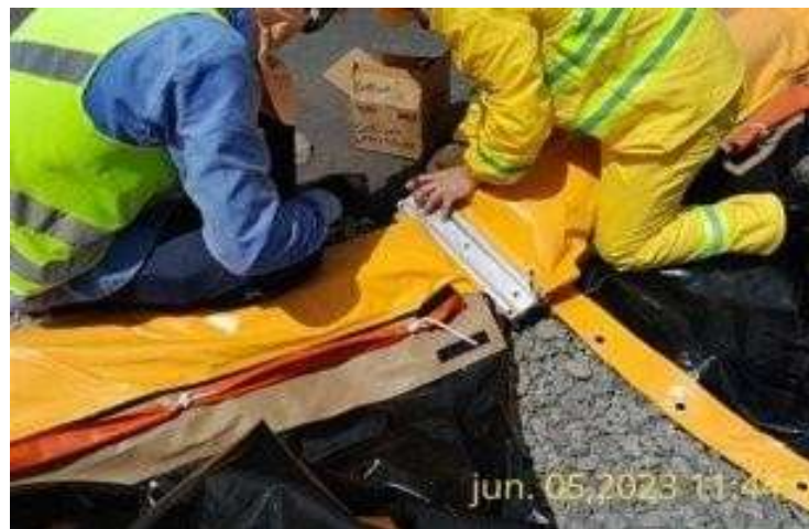
Figura 7 - Montagem e conexão dos módulos da barreira flutuante.
