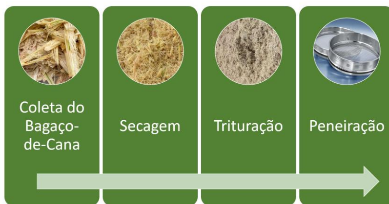
Figura 14 - Preparação da biomassa de cana-de-açúcar.
