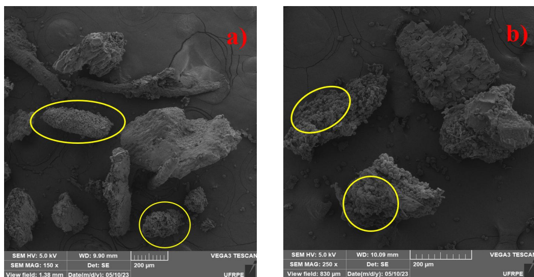
Figura 10 – Micrográficos de MEV para as amostras puras de cascas de coco babaçu in natura com magnitudes de: a) 150 e b) 250 vezes.
