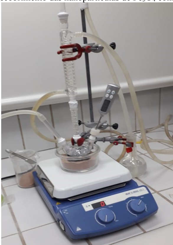
Figura 5: Sistema para recobrimento das nanopartículas de \text{Fe}_3\text{O}_4 com prata
