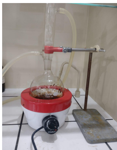
Figura 5 – Sistema de refluxo para tratamento básico das fibras.
