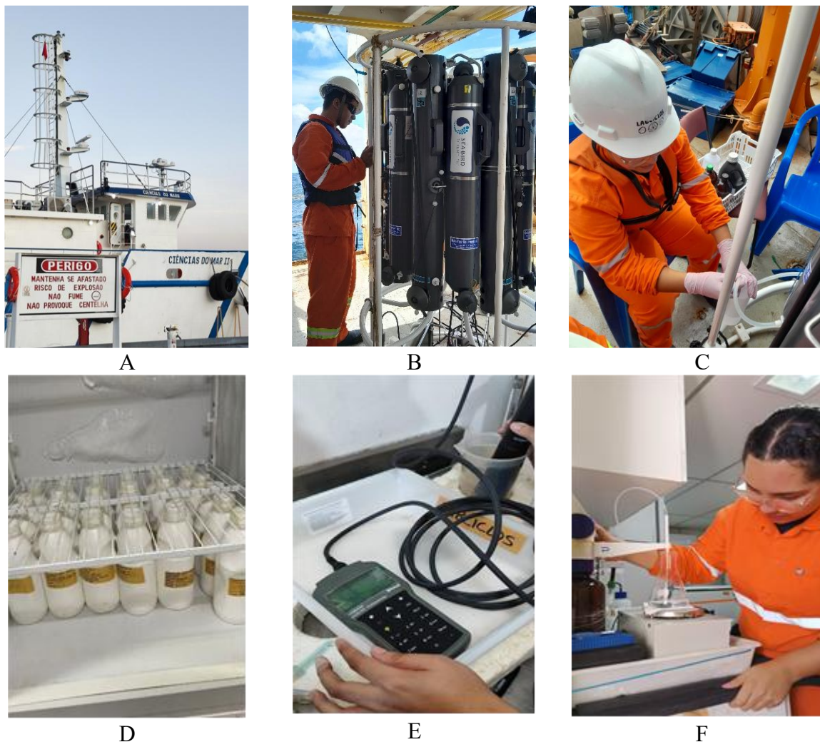
Figura 3. Equipamentos utilizados na coleta de água: (A) Embarcação “Ciências do Mar II”; (B) Garrafa de Niskin na Rosset ; (C) Coleta de água; (D) Armazenamento das amostras de MPS; (E) Multiparâmetro HANNA HI 98494 para a medição dos parâmetros hidroquímicos; (F) Determinação do oxigênio dissolvido pelo método de Winkler.
