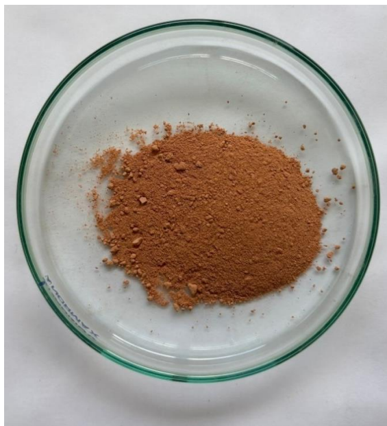
Figura 21 – Argila bruta após calcinação a 500°C.
