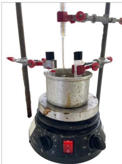
Figura 16 – Sistema reacional de hidrogenação de furfural a álcool furfurílico.
