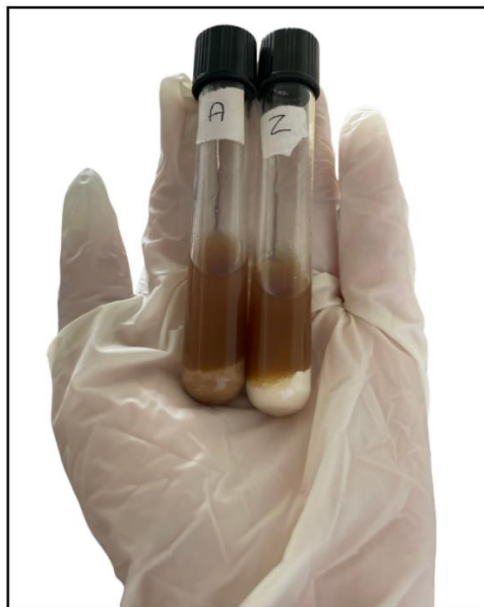
Figura 15 – Frascos com solução e catalisador adicionados, etapa prévia à agitação.
