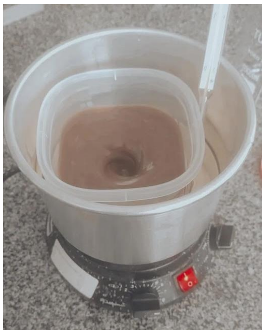
Figura 12 – Recipiente com solução básica em banho de óleo.
