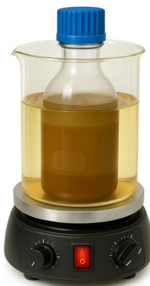
Figura 9 – Montagem do tratamento ácido da argila em banho de óleo.
