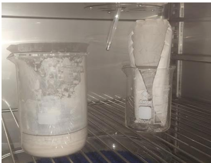
Figura 11 – Argila em fase de secagem na estufa.
