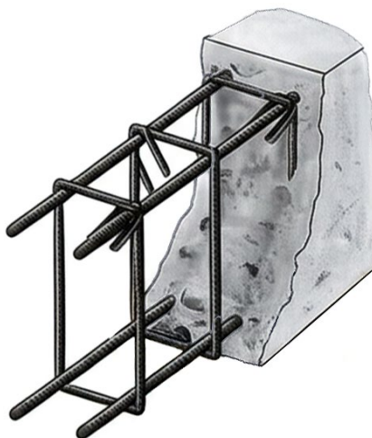
FIGURA 1. Representação de um elemento de concreto armado.
