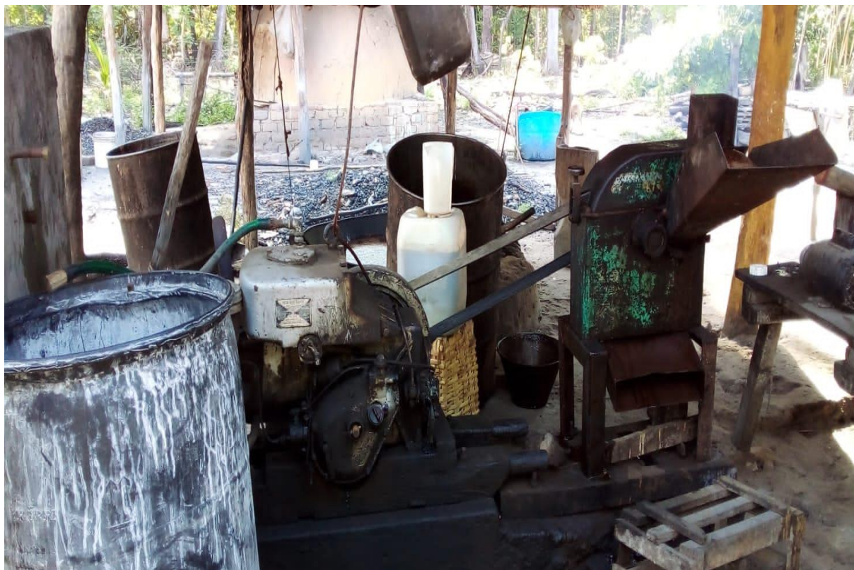
Fotografia 7: Motor a óleo diesel, utilizado na serragem da mandioca, moer cana-de-açúcar.
