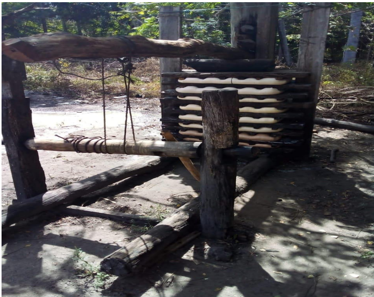
Fotografia 2: Prensa de madeira feita para prensar e enxugar a massa ralada de mandioca mansa.
