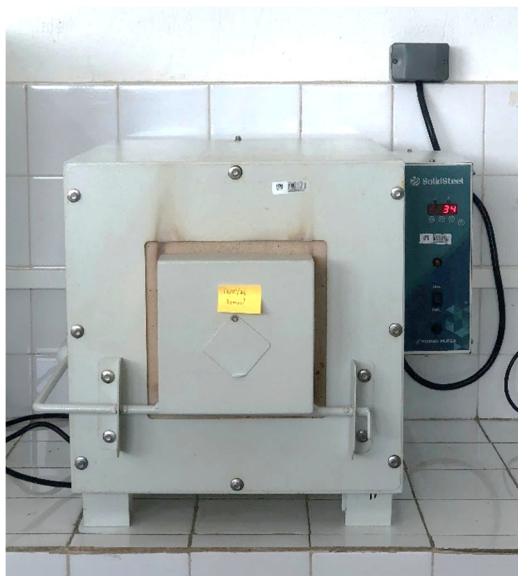
Figura 29: Forno-mufla utilizado no ensaio de teor de fibras.
