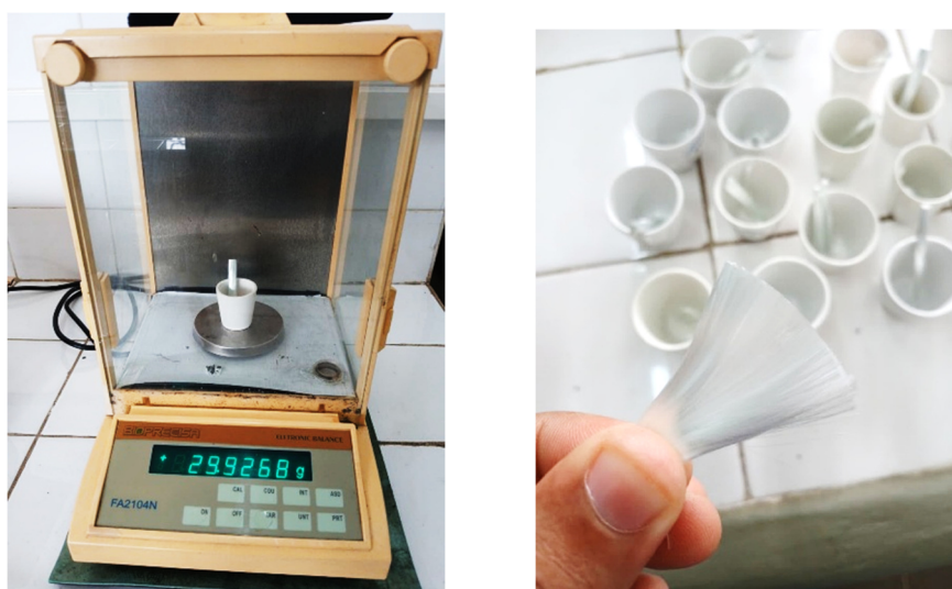
Figura 30: Conjunto fibra mais cadinho sendo pesado (à direita); e as fibras de vidro sem a resina após combustão (à esquerda).
