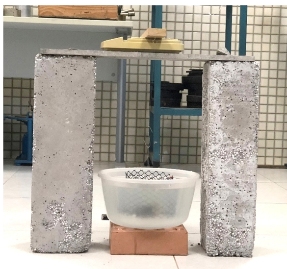
Figura 22: Balança analítica e recipiente com água utilizados para obter o diâmetro efetivo.
