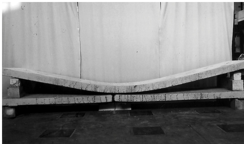
Figura 11: Laje com telas de aço sobre a laje com telas de GFRP, após atingirem a ruptura.
