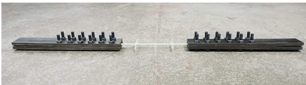
Figura 34: Barra L4 fixada nas chapas metálicas.
