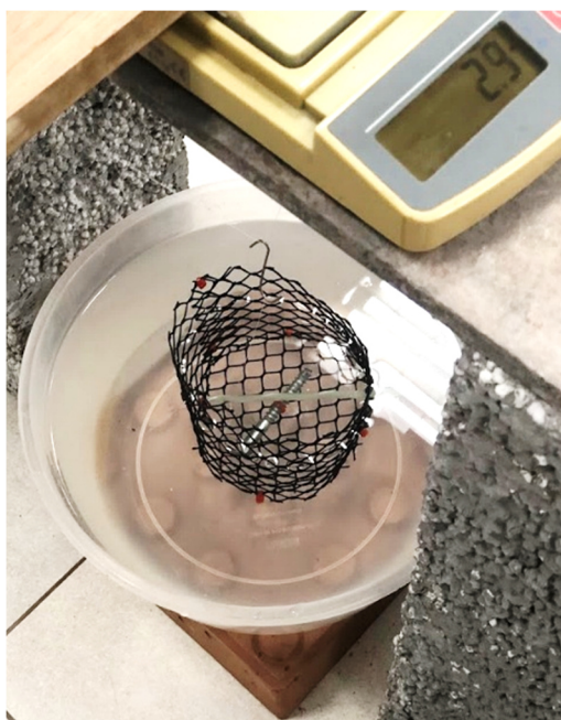
Figura 24: Provete de 4 mm imerso para medição de Massa 2.
