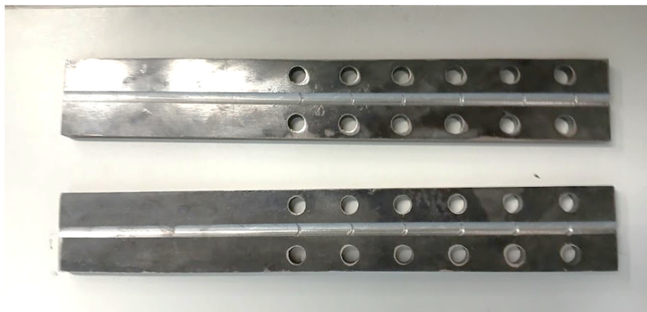
Figura 33: Chapas metálicas produzidas para ensaio de tração.
