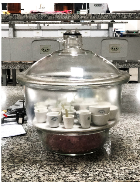
Figura 28: a) Cadinhos, no dessecador, após saírem da estufa; b) Cadinhos com corpos de prova sendo pesados em balança analítica.
