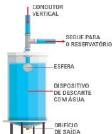
Figura 5. Reservatório de descarte com esfera flutuante
