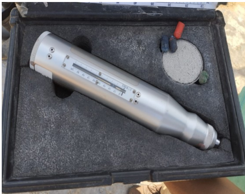
Figura 20 – Esclerômetro usado no teste da marca Controls
