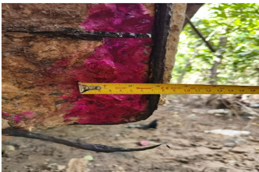
Figura 23 – Processo do ensaio de carbontação em execução
