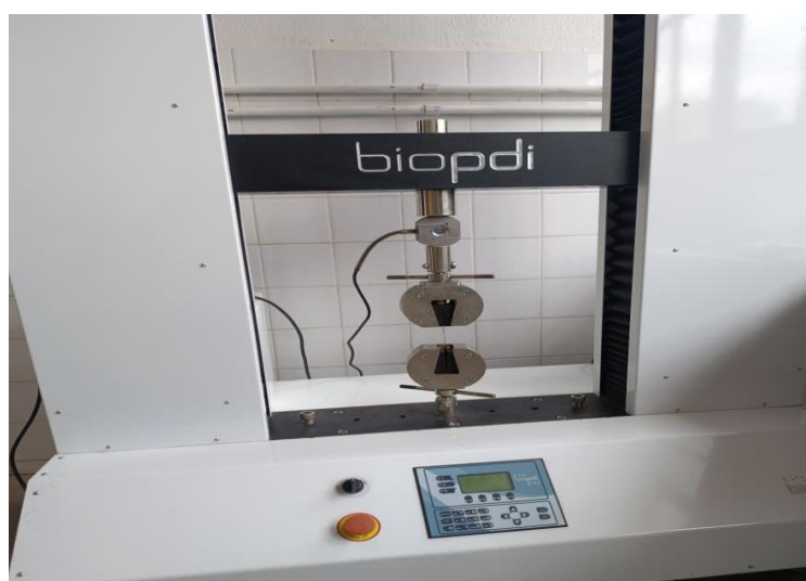
Figura 11: Equipamento de tração e elasticidade (BioPDI)
