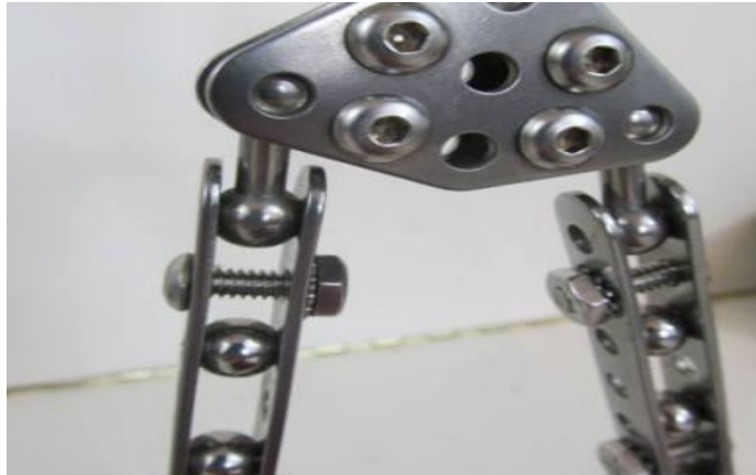
Figura 7 - Sistema de articulação ball-and-socket em boneco moderno.
