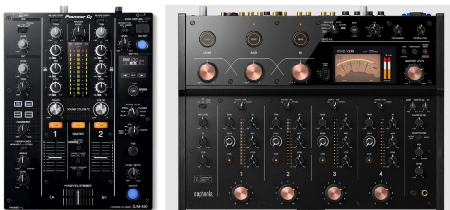
Figura 2-1: À esquerda, o Pioneer DJM-450 representando a topologia puramente digital (DSP); à direita, o AlphaTheta Euphonia, que adota uma abordagem híbrida integrando processamento digital com transformadores analógicos de saída.
