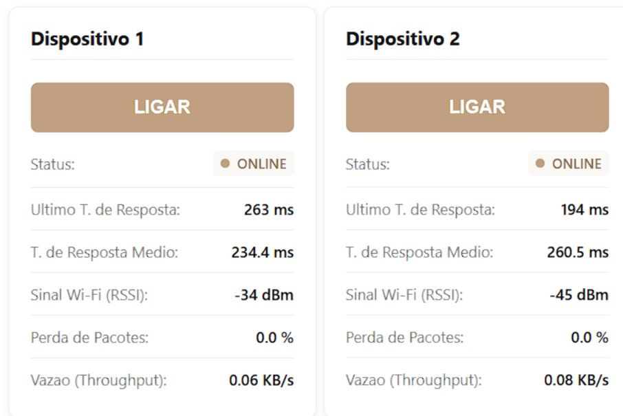
Figura 61 - Cartões dos dispositivos 1 e 2 para do Cenário de Arquitetura Cross-band 2.4 – 5.8 GHz
