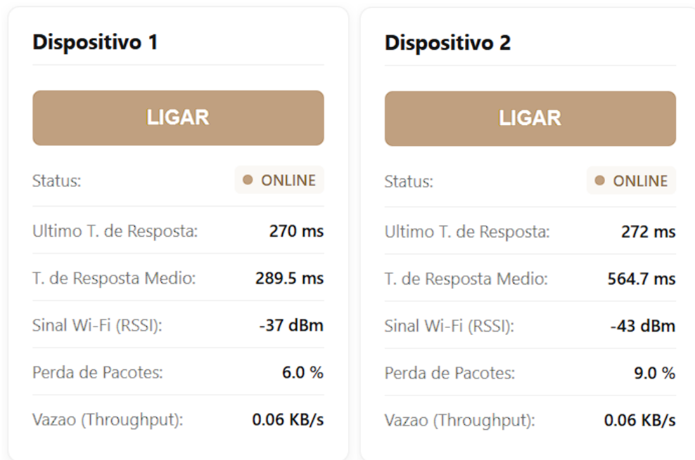
Figura 58 - Cartões dos dispositivos 1 e 2 para do Cenário de Arquitetura Cross-band 2.4 – 2.4 GHz
