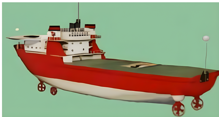
Figura 9 – CyberShip I , um modelo de um navio de suprimento offshore , escala 1:70 (Fonte: (STRAND, 1999)).
