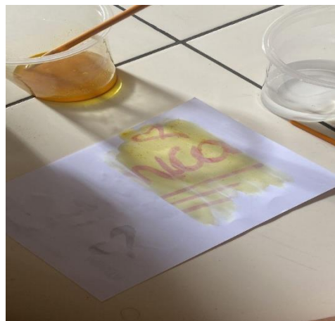
Figura 8 — Resultado da utilização da cúrcuma como indicador, evidenciando a mudança de coloração em meio básico.
