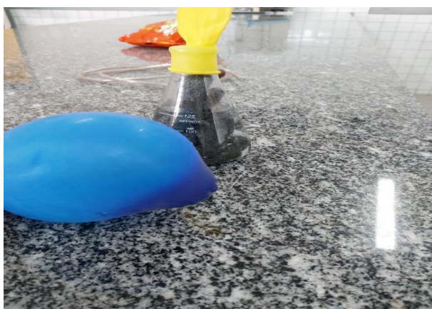
Figura 3 — Formação de gás hidrogênio a partir da reação entre ácido sulfúrico e palha de aço, em atividade experimental realizada com alunos do 2º ano do Ensino Médio.
