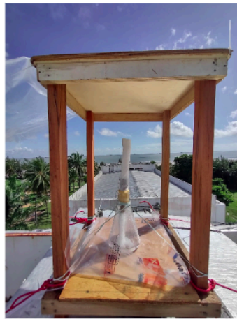
Figura 2 - Aparato de vela úmida mostrando a estrutura de madeira e o erlenmeyer.
