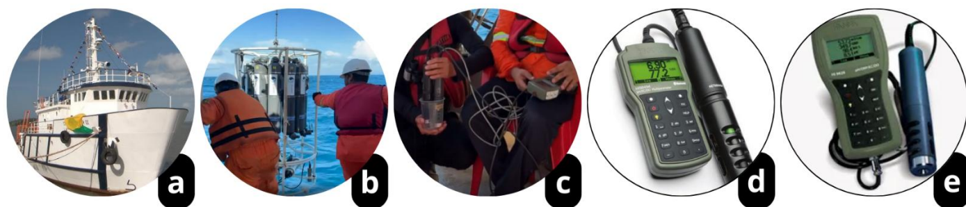
Figura 2 – Navio Oceanográfico Ciências do Mar II (a); Sistema Rosette equipado com CTD e 12 garrafas de coleta Niskin de 5L(b); Aferição dos parâmetros físico-químico (c) utilizando as multiparâmetros da marca HANNA, modelos HI 98494 (d) e HI 9828 (e).
