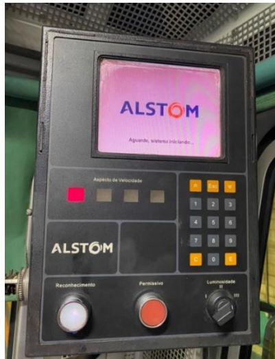
Figura 12 – Módulo Operador MOP do ATC (Automatic Train Control)
