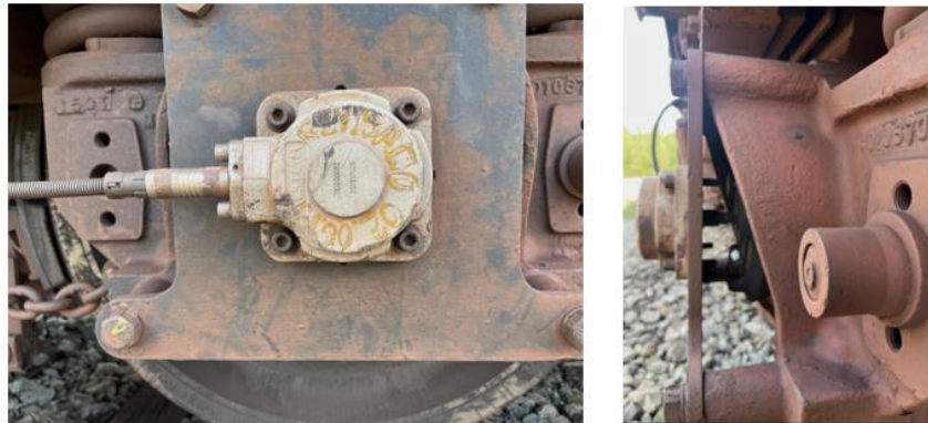
Figura 16 – Tacômetro instalado na ponta do eixo da locomotiva
