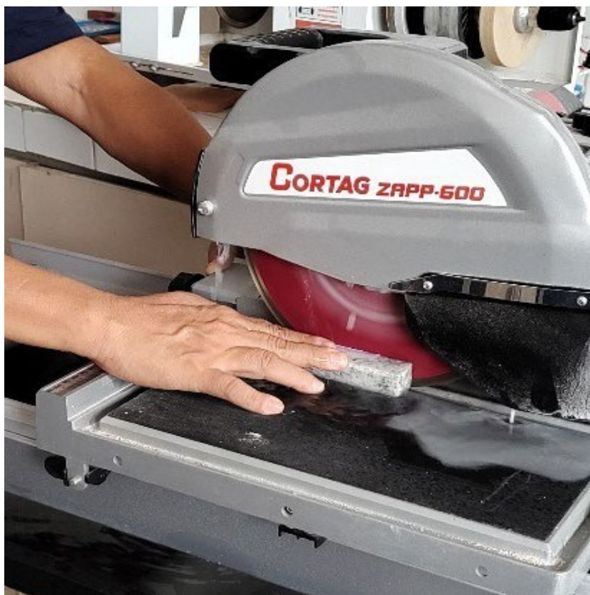
Figura 11 - Corte com o cortador elétrico CORTAG Zapp 600
