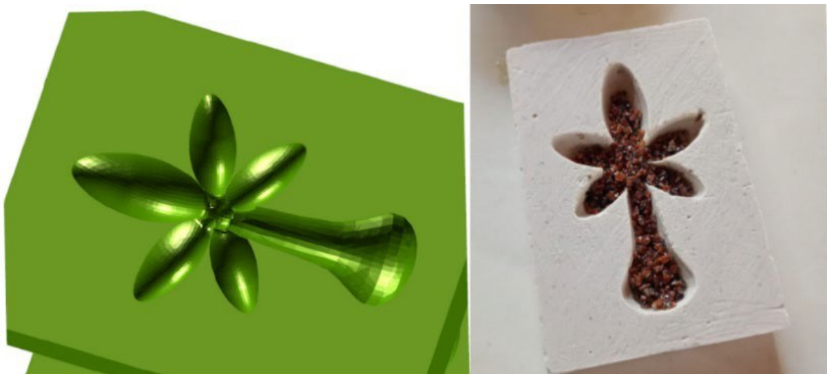
Figura 33 - Moldes da “Coleção do Exílio” para a técnica inlay
