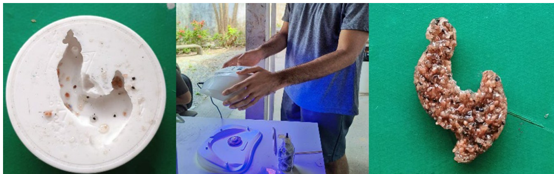
Figura 21 - Uso de molde, cabine de LED UV e peça obtida
