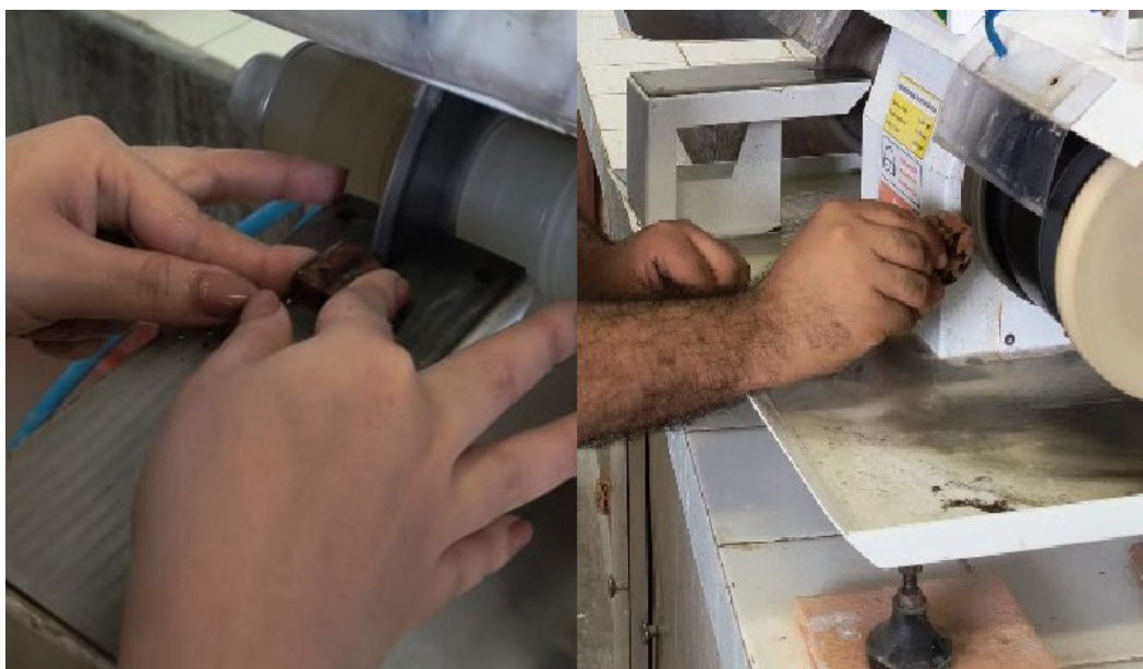
Figura 16 - Corte da amostra na lapidadora e uso do rebolo diamantado
