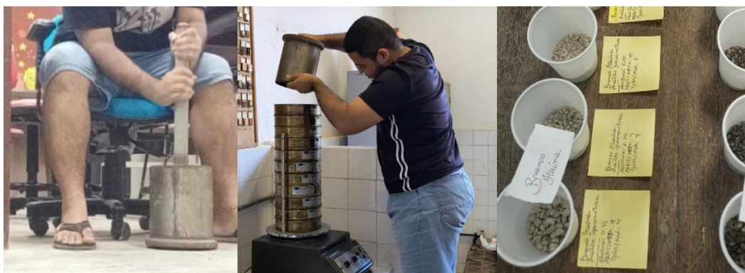
Figura 20 - Trituração, agitação eletromagnética e separação dos fragmentos
