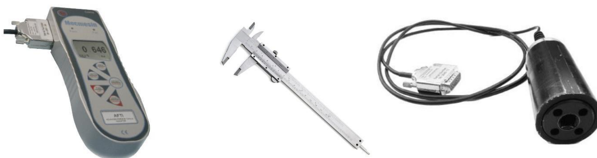
Figura 13 – À esquerda, Dinamômetro digital. Ao centro, paquímetro. À direita, Transdutor de torque móvel.
