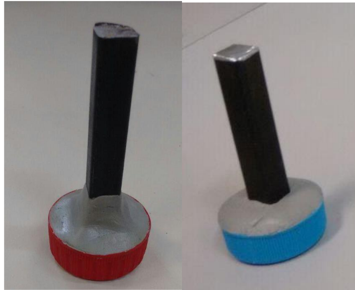
Figura 16 – Tampas modificadas para o teste de mensuração de força.
