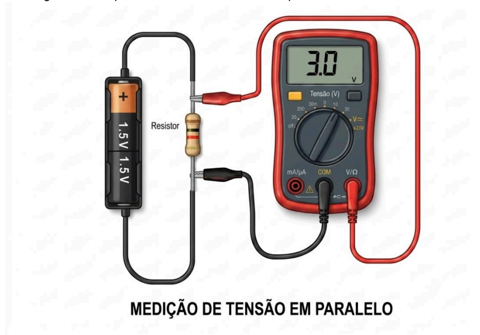
Figura 8 — Esquema do circuito: voltímetro em paralelo com o resistor
