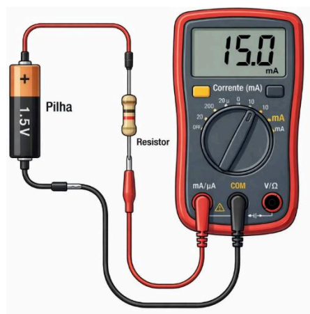
Figura 7 — Esquema do circuito: amperímetro em série com o resistor
