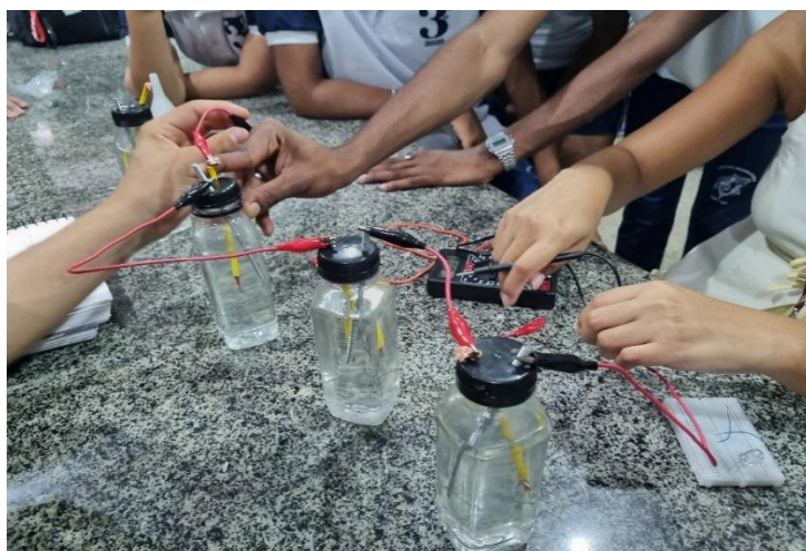
Figura 12: Atividade prática envolvendo a montagem de circuitos elétricos com pilhas caseiras associadas em série e em paralelo, utilizando protoboard, resistores e LED.
