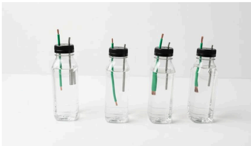
Figura 5: Montagem das pilhas caseiras: células eletroquímicas com eletrólito básico (água sanitária), eletrodo de cobre e eletrodo de zinco.
