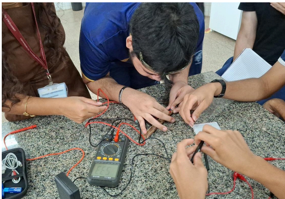
Figura 16: Atividade prática envolvendo a montagem de circuitos elétricos com pilhas convencionais e cano de PVC.
