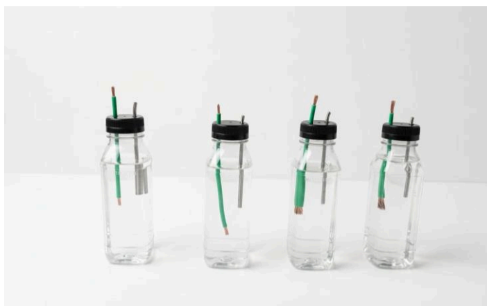
Figura 5 — As 4 células eletroquímicas (pilhas caseiras com garrafas PET)
