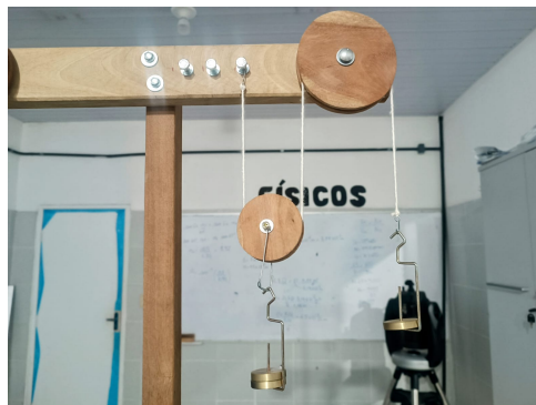
Figura 18: Experimento com uma Roldana Fixa e uma Móvel
