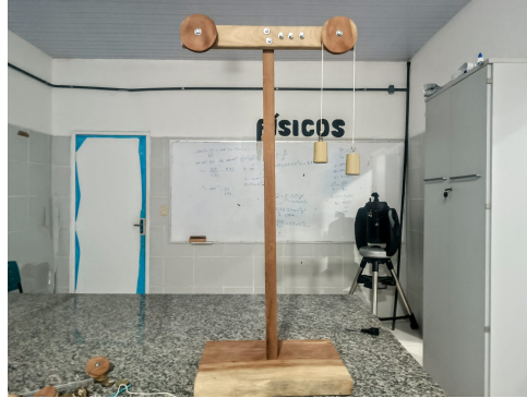
Figura 17: Experimento com uma Roldana Fixa
