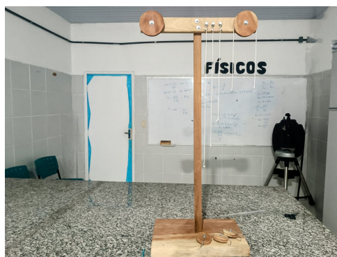
Figura 16: Aparato de madeira com duas roldanas fixas
