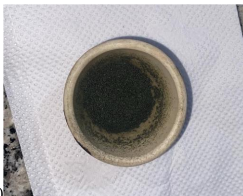
F) Figura 6F - Amostra final depois da calcinação
