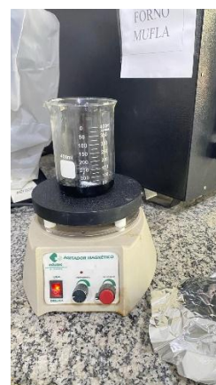
Figura 3A -Solução esverdeada contendo o precursor de Níquel e gelatina sob agitação Figura 3B -Solução de coloração escura contendo o precursor de Cromo e gelatina sob agitação.
