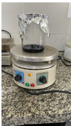
Figura 4 - Mistura das soluções precursoras para formação do complexo metal-proteína.
