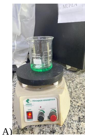
Figura 3A -Solução esverdeada contendo o precursor de Níquel e gelatina sob agitação Figura 3B -Solução de coloração escura contendo o precursor de Cromo e gelatina sob agitação.
