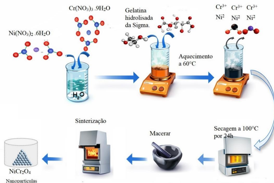
Figura 8 -Representação esquemática do método sol-gel proteico usado na produção de nanopartículas \text{NiCr}_2\text{O}_4
