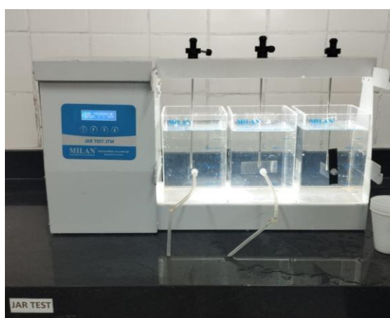
Figura 2: Imagem do Equipamento Jar Test utilizado nos ensaios de coagulação, floculação e decantação.
