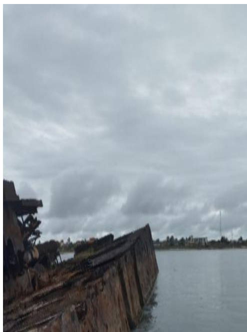
Figura 1: Embarcação inclinada e afetada por corrosão marinha.
