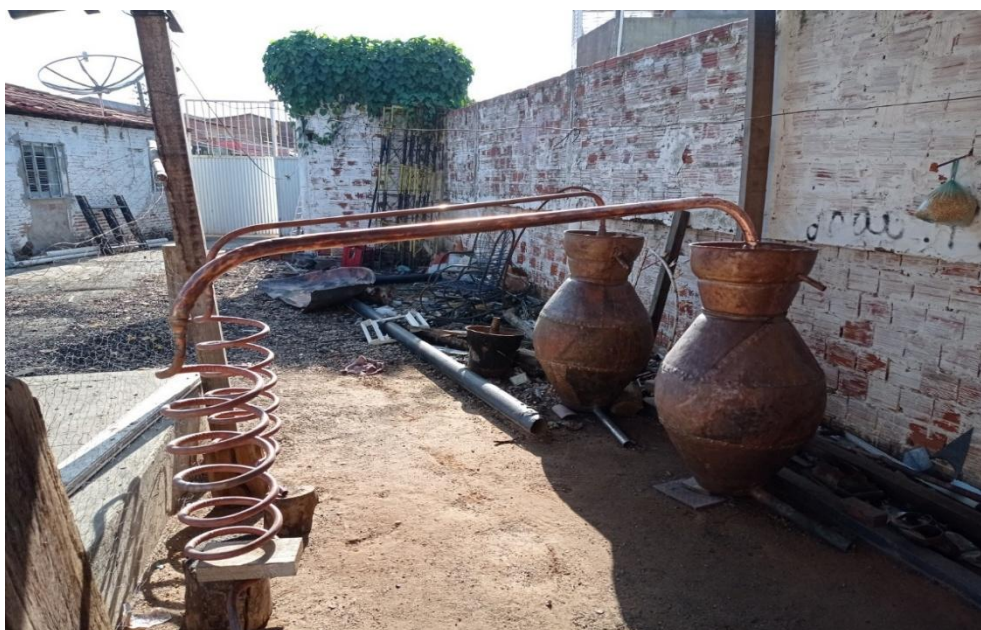
Imagem 1: Sistema de destilação com alambique de cobre
