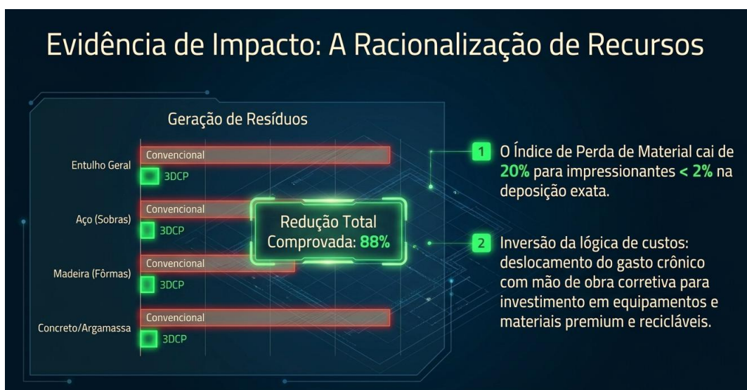
Figura 13 – Comprovação da redução na geração de resíduos usando a impressão 3D.
