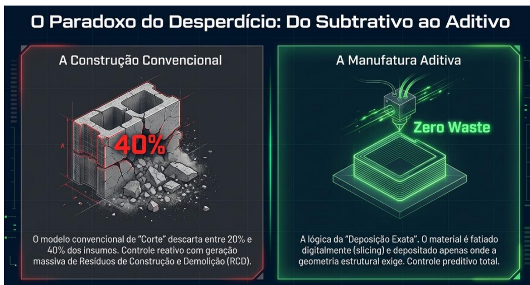
Figura 1 – Comparativo do desperdício do método tradicional vs. o método de impressão 3D
