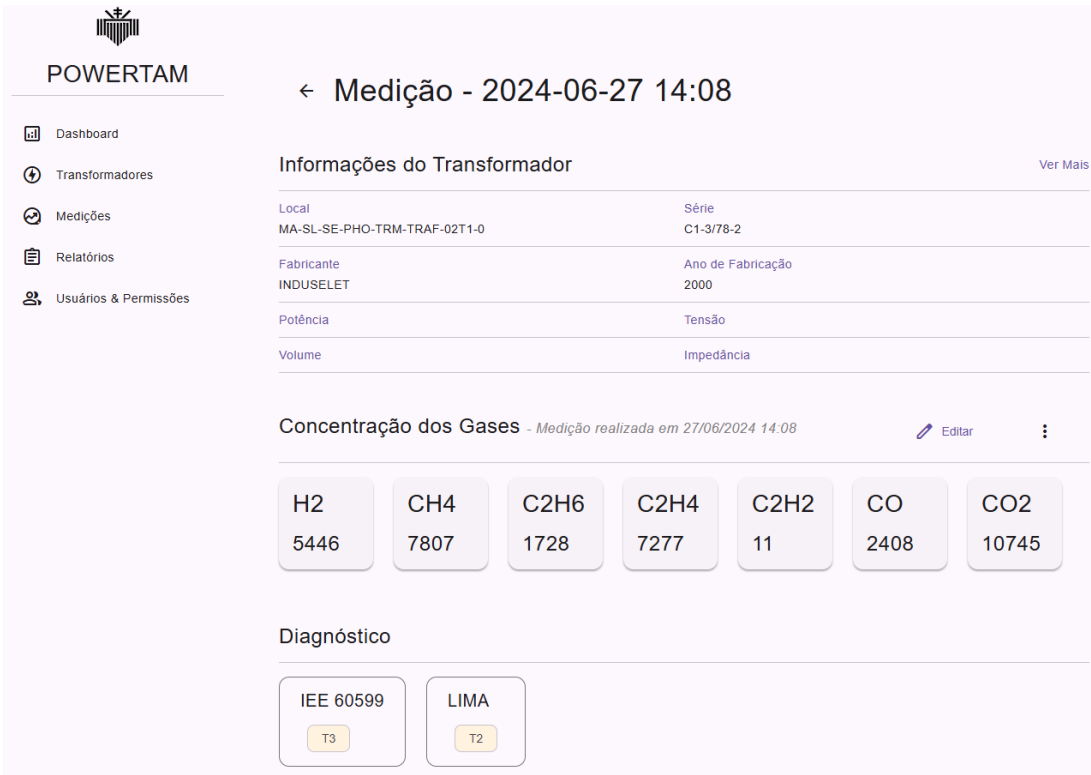
Figura 6.8: Diagnóstico de Falha Térmica gerado pela plataforma
