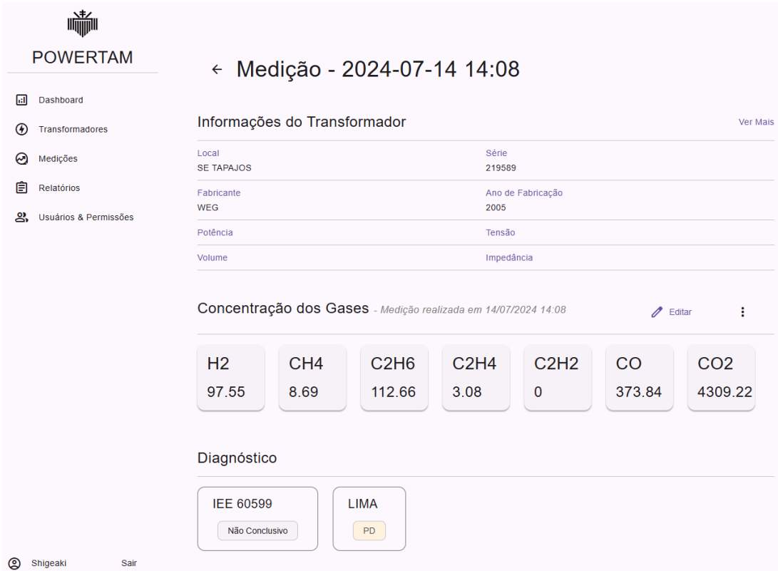
Figura 6.9: Diagnóstico de Descarga Parcial gerado pela plataforma
