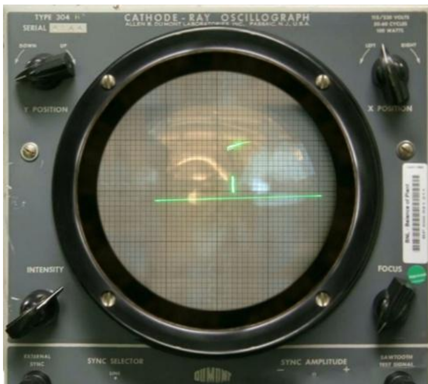
Figura 1 - Tennis for Two em um osciloscópio de laboratório Dumont tipo 304-a.
