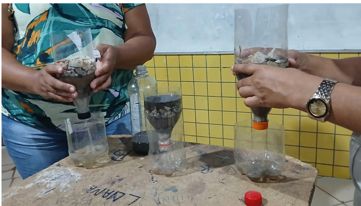
Figura 10 – Filtro confeccionado com garrafa PET
