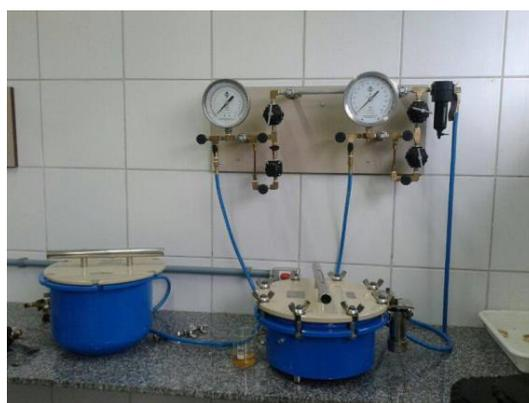
Figura 2. Panela de Richards, utilizada na determinação da curva de retenção de água no solo.
