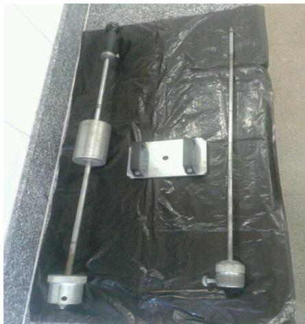
Figura 3. Permeâmetro de Guelph utilizado para a determinação da taxa da velocidade de infiltração e condutividade hidráulica no solo.
