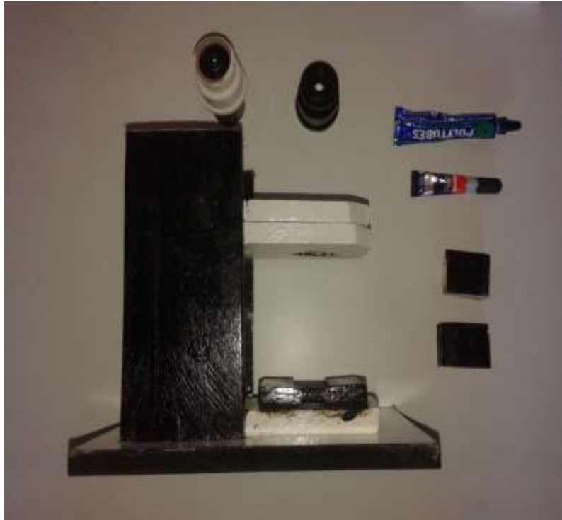
Figura 06: Base superior do microscópio caseiro
