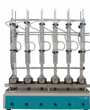
Figura 7- Aparelho extrator de Soxhlet para extração de Lipídios
