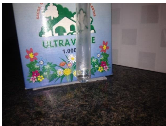
Figura 12: Uréia fundida após aquecimento.
