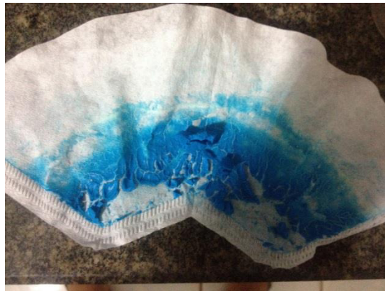
Figura 4: Precipitado filtrado e seco.
