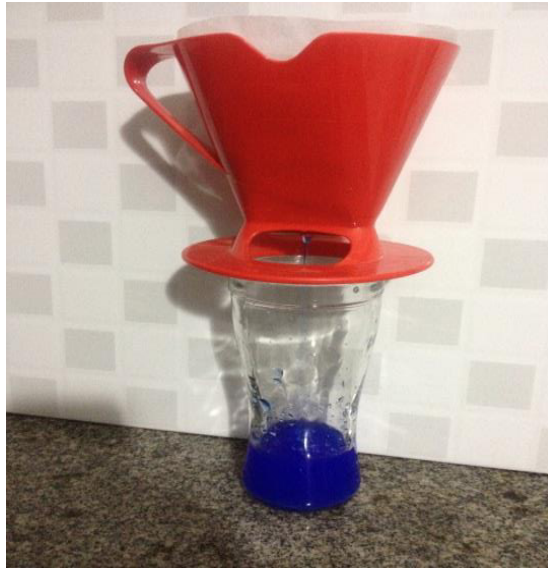
Figura 3: Filtração do precipitado formado.
