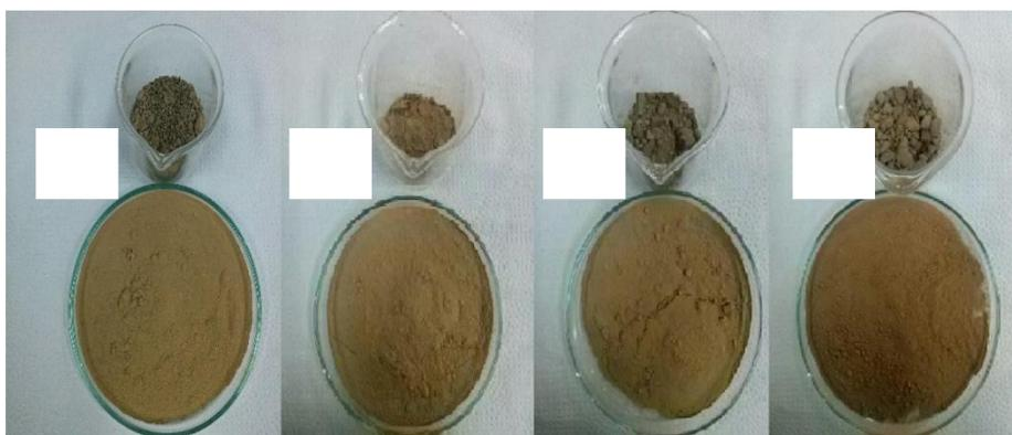
As argilas obtidas (figura 7) não apresentaram nenhum tipo de mudança no seu aspecto físico. A condutividade de todos os materiais foram mantidos na faixa de 39,0 mV, e pH 5,9, que indicam a remoção de qualquer presença de excesso de brometo, o uso dessa faixa foi condicionada pela água utilizada no processo, na literatura são encontrados faixas maiores, que são limitadas pela funcionalização da argila obtida (CAVALCANTI et al., 2009).
