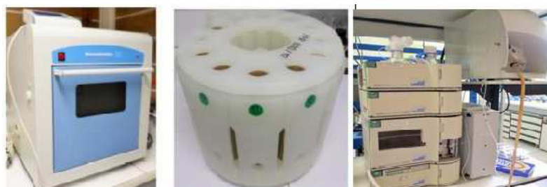
Figura 10: Micro-ondas (esquerda) e reatores (centro) utilizado para extração e HPLC utilizado para determinação de polifenóis.
