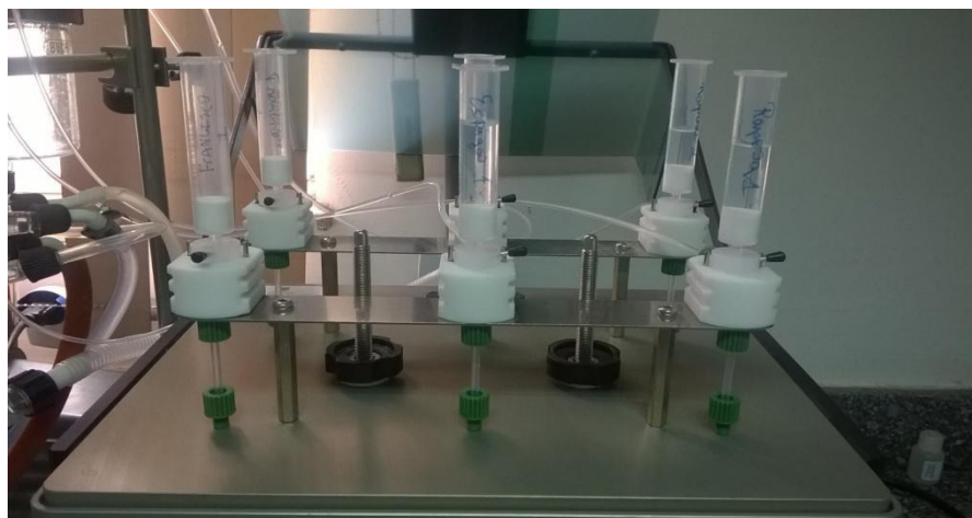
Figura 4.6: Condicionamento de cartucho para concentração da amostra no Syncore Anayst.
