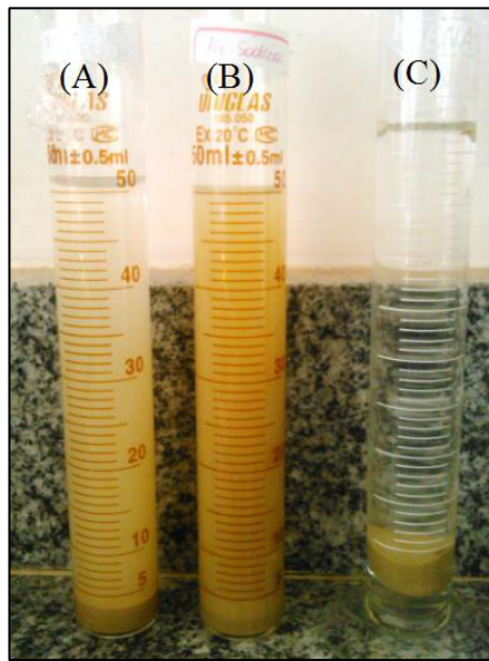
Figura 10. Comportamento em água das argilas AN (A), AHS (B) e AM (C)
