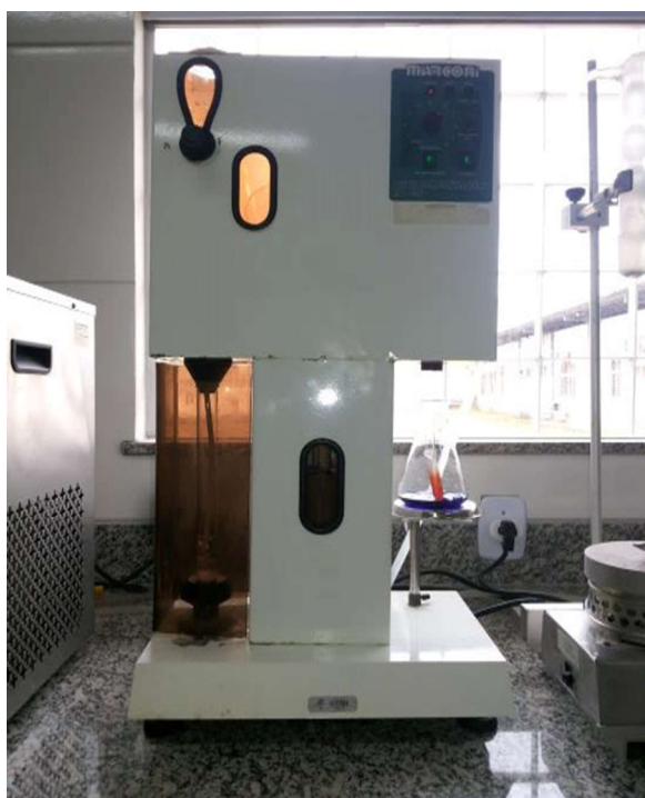
Figura 14 - Aparelho analisador de amônia para determinação de nitrogênio total na etapa de destilação
