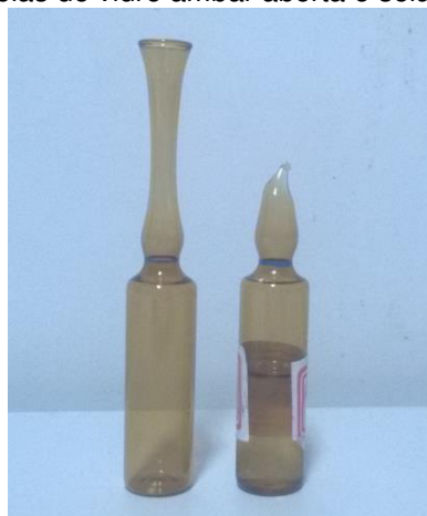
Figura 18: Ampolas de vidro âmbar aberta e selada pelo maçarico
