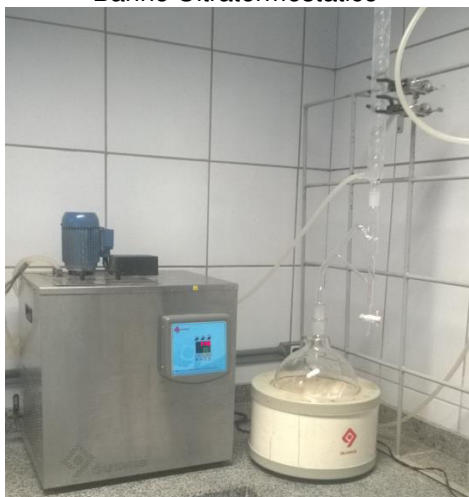
Figura 14: Sistema de Hidrodestilação com Banho Ultratermostático
