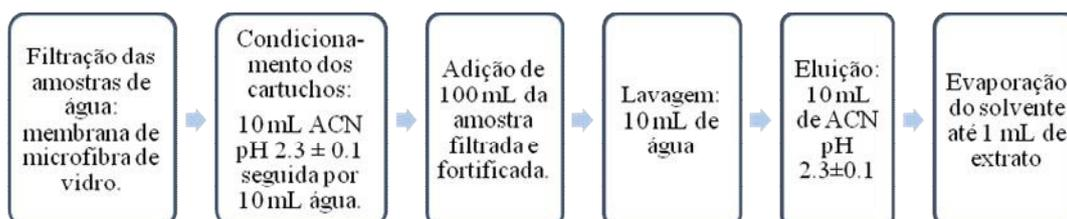
Figura 3: Procedimento de extração em fase sólida utilizado para remover o analito da matriz.
