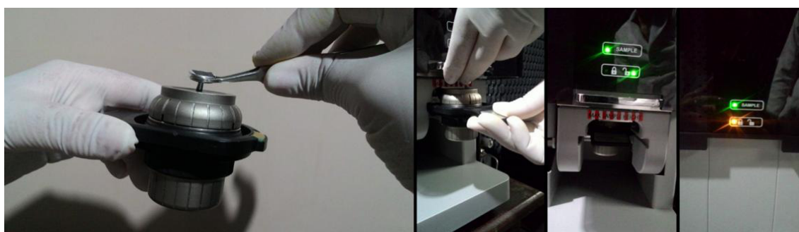
Figura 10 – Procedimento para acoplar o stub no Sample Holder e inserir o mesmo no equipamento.
