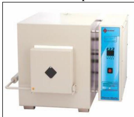
Figura 7 -Forno mufla utilizado para análises de cinzas
