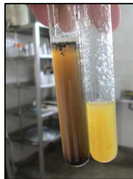
Figura 4- Teste de amido, antes e depois da utilização de enzimas
