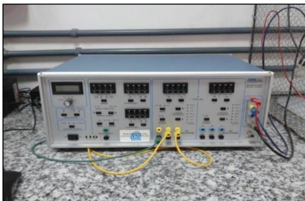
**Fig.9** – Imagem ilustrativa do bipotenciostato PINE (MODELO AFCBP1)
