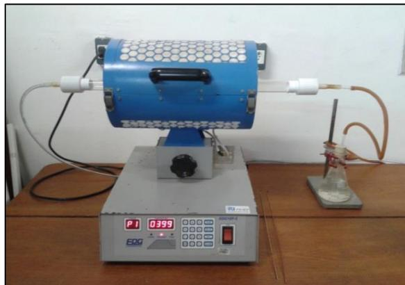
**Fig.13** – Imagem ilustrativa do forno tubular EDG (MODELO EDG10P-S)
