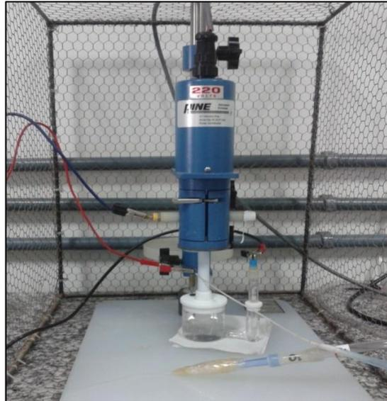
**Fig.10** – eletrodo de disco rotatório utilizado nos experimentos. PINE (MODELO AFCBP1)
